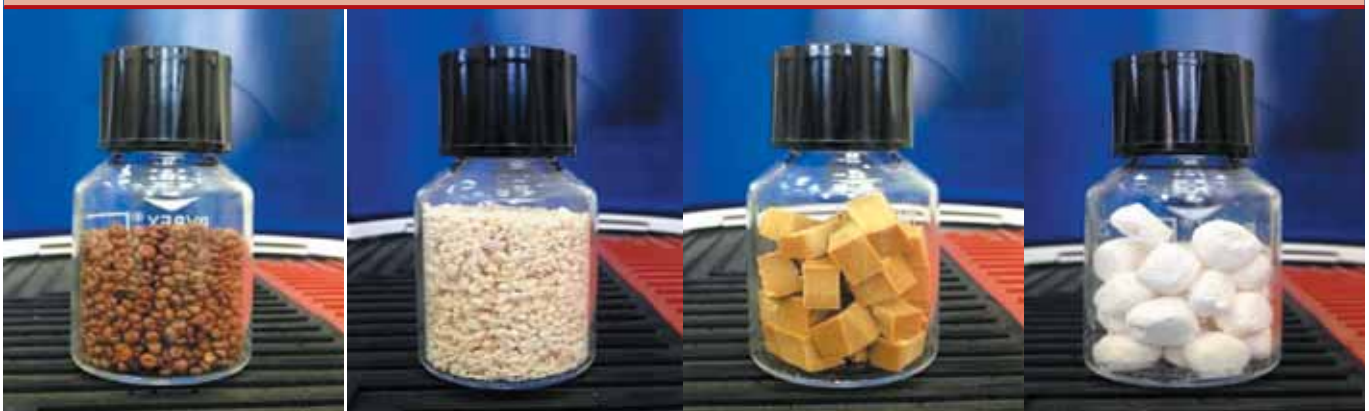
РИС.2 ОБРАЗЦЫ ПРОДУКТОВ ПРОЛОНГИРОВАННОГО ДЕЙСТВИЯ ДЛЯ ИНГИБИРОВАНИЯ КОРРОЗИИ И СОЛЕОТЛОЖЕНИЯ
