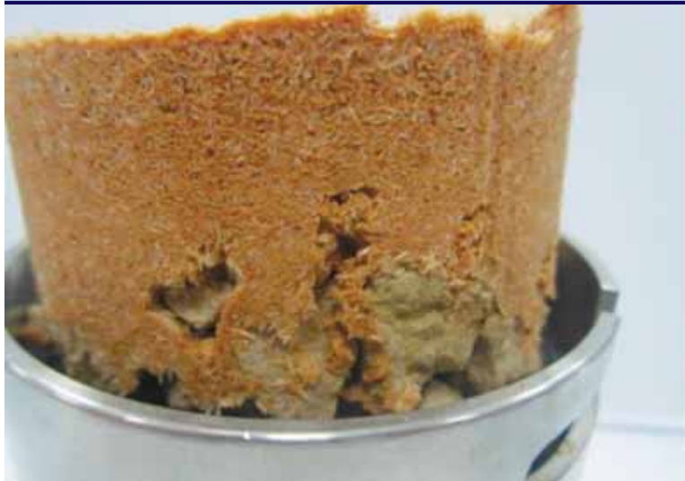
РИС. 1 ТЕХНОЛОГИЯ CAVEBLOCK™ МОМЕНТАЛЬНО ОБРАЗУЕТ ГЛИНИстую КОРКУ ДАЖЕ НА БОЛЬШИХ ТРЕЩИНАХ
