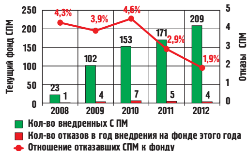
Динамика удельного количества отказов СПМ к общему количеству внедрения в первый год эксплуатации
